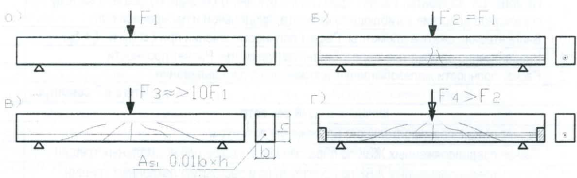
**Рисунок 1.1 – Характер разрушения балок**
