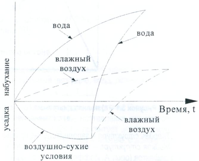
Рисунок 3.2 – Деформации бетона в разных средах
