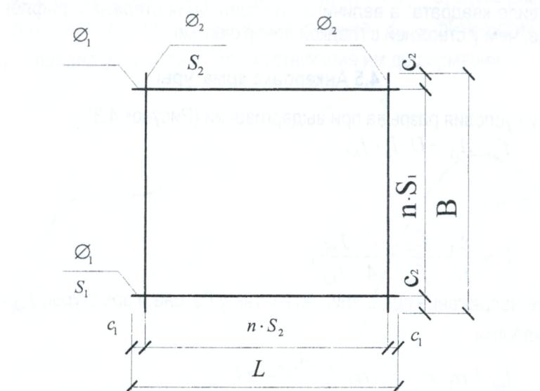
Рисунок 4.4 – Рабочий чертеж арматурной сетки
