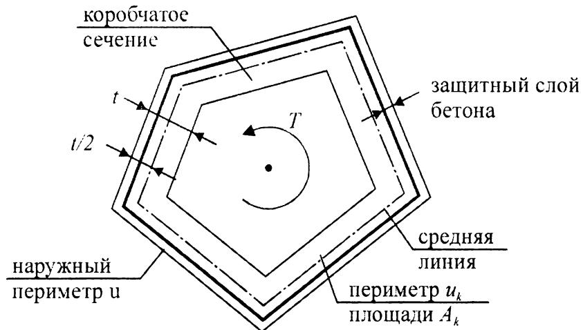
Рисунок 10.4 – Схема сечения элемента, работающего на кручение
