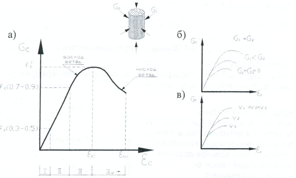
Рисунок 3.1 – а) полная диаграмма ( $\sigma - \varepsilon$ ), б) с изменением напряженного состояния, в) с изменением скорости загружения
