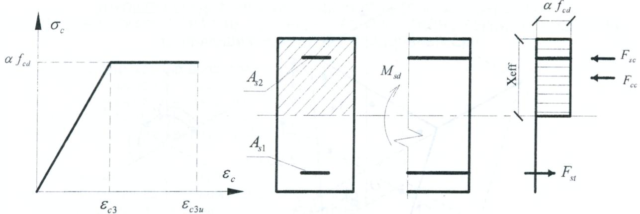
**Рисунок 5.8 – Условия использования метода предельных усилий**
