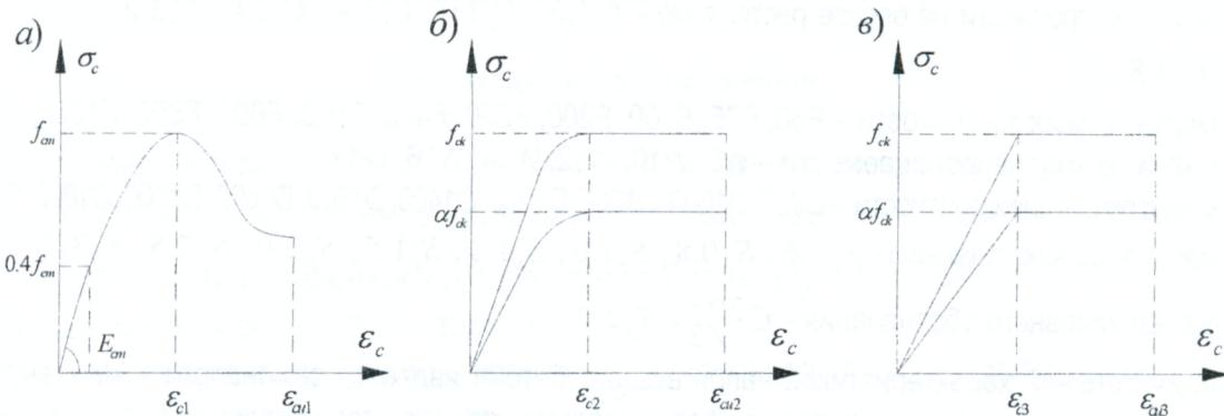
Рисунок 3.6 – Диаграммы “ $\sigma – \varepsilon$ ”: полная (а), линейно-параболическая (б), билинейная (в)
