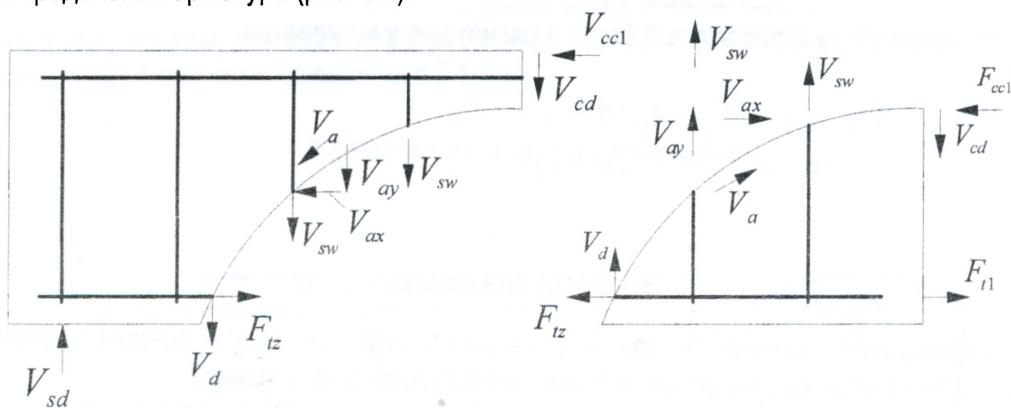
**Рисунок 8.1 – Схема внутренних усилий в наклонном сечении**
