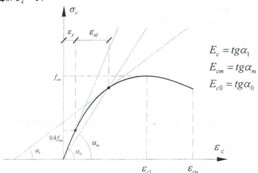
Рисунок 3.3 – Диаграмма “ $\sigma - \varepsilon$ ” для бетона при однократном загружении
