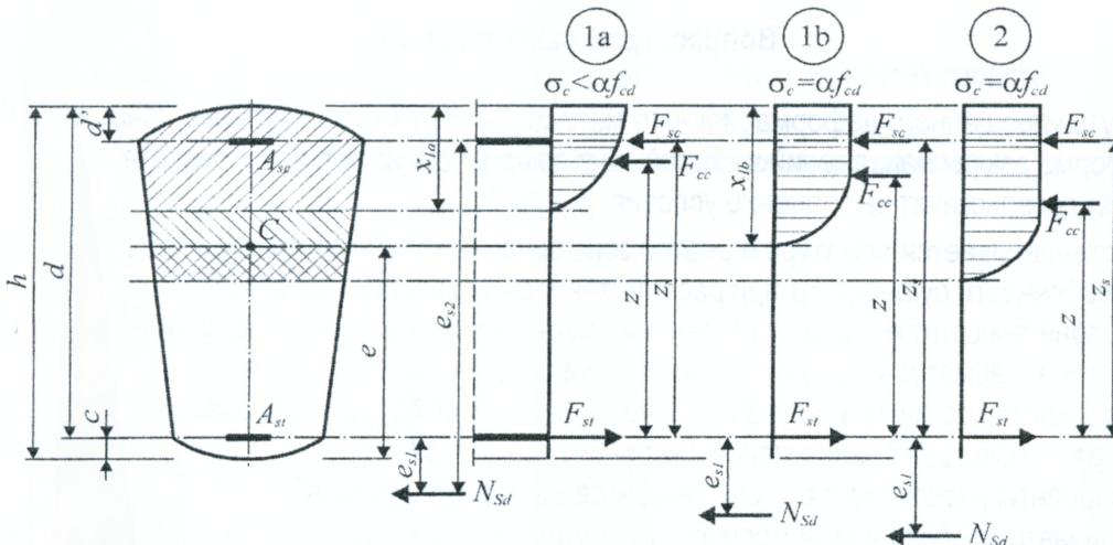
Рисунок 6.8 – Схемы усилий в расчетном сечении внецентренно растянутого элемента при  $M_{sd} < 0$  (случай малых эксцентрикитетов) – (а) и  $M_{sd} > 0$  (случай больших эксцентрикитетов) – (б)
