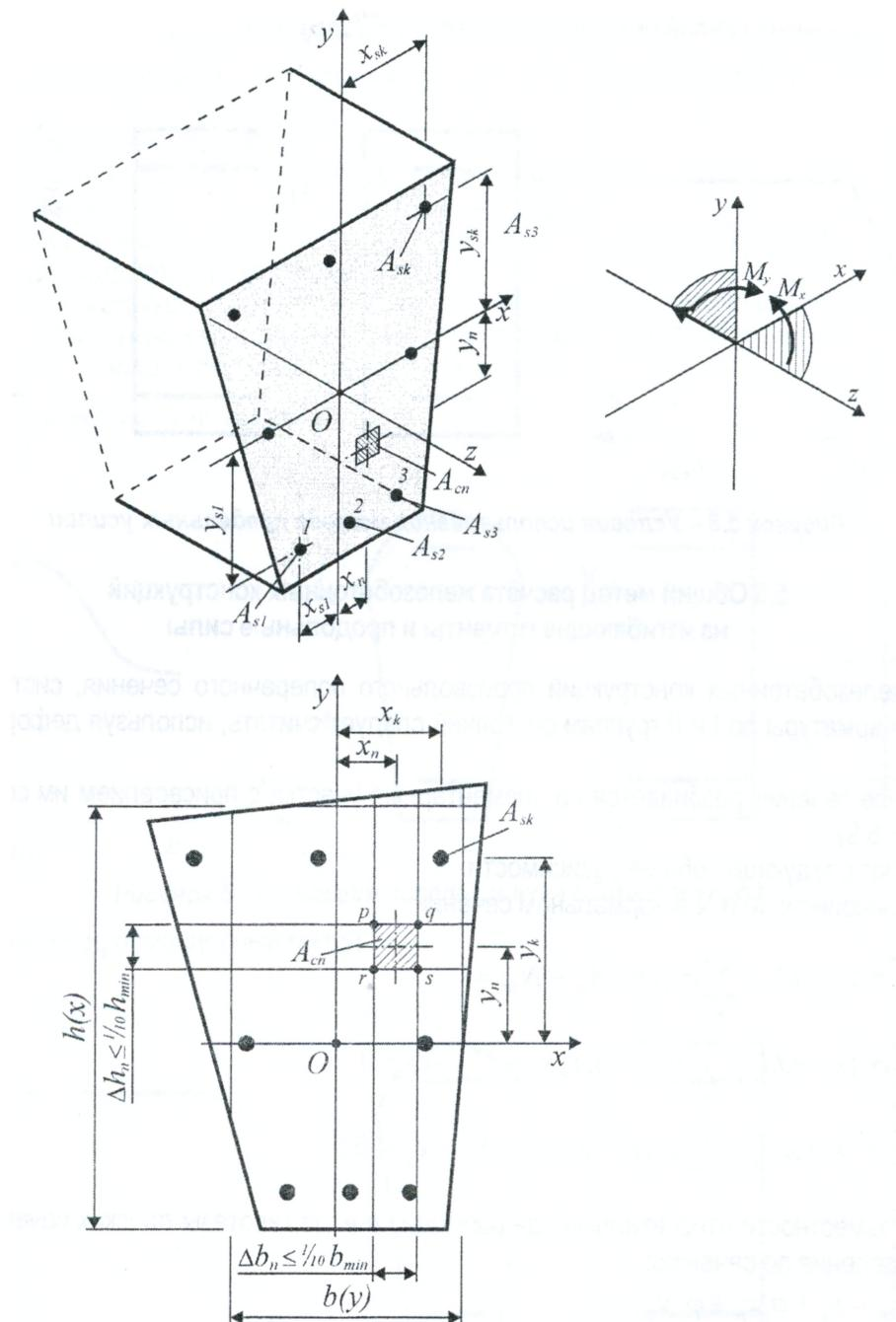
**Рисунок 5.9 – Разбиение поперечного сечения на элементарные участки**
