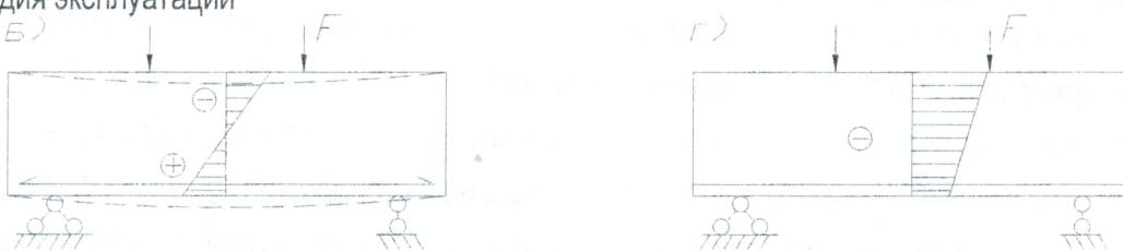
**Рисунок 12.1 – Распределение напряжений в балке с обычной арматурой (а, б) и с преднатяженной арматурой (в, г).**
