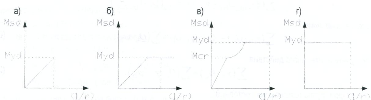
Рисунок 2.1 – Зависимости  $M_{sd} - 1/r$  для расчётных моделей соответственно, где -  $M_{cr}, M_{yd}$  – моменты появления трещин, появление пластической деформации
