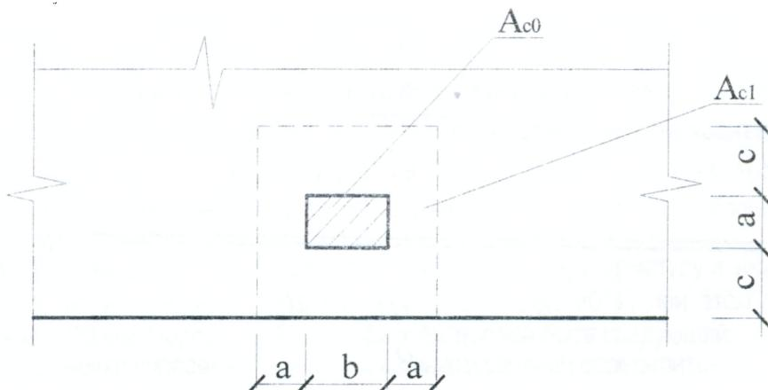
Рисунок 9.1 – Схема для определения  $A_{c0}$ ,  $A_{c1}$ ,  $k_f$
