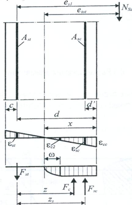
Рисунок 6.7 – Принимаемая в расчете схема усилий
