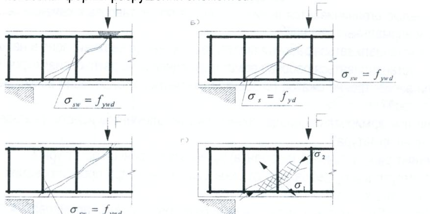
**а) разрушение по сжатой зоне;**
