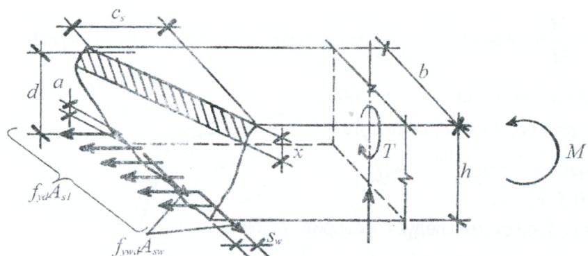
**Рисунок 10.1 – Схема усилий в пространственном сечении**
