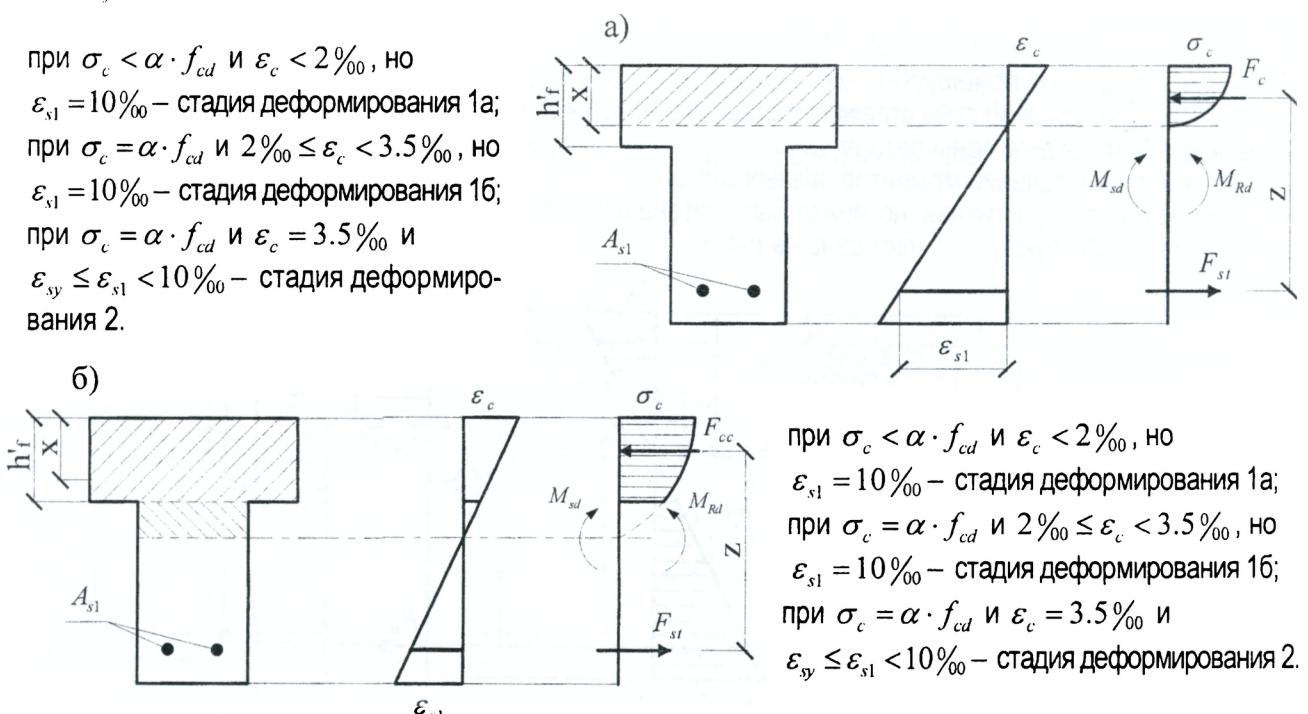
Рисунок 6.5 – Возможные варианты расчета тавровых сечений и формы эпюров в сжатой зоне
