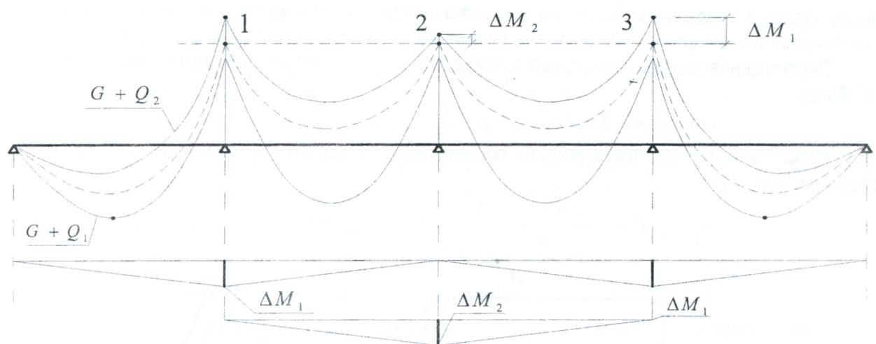
Рисунок 11.3 – Выравнивание опорных моментов в неразрезной балке
