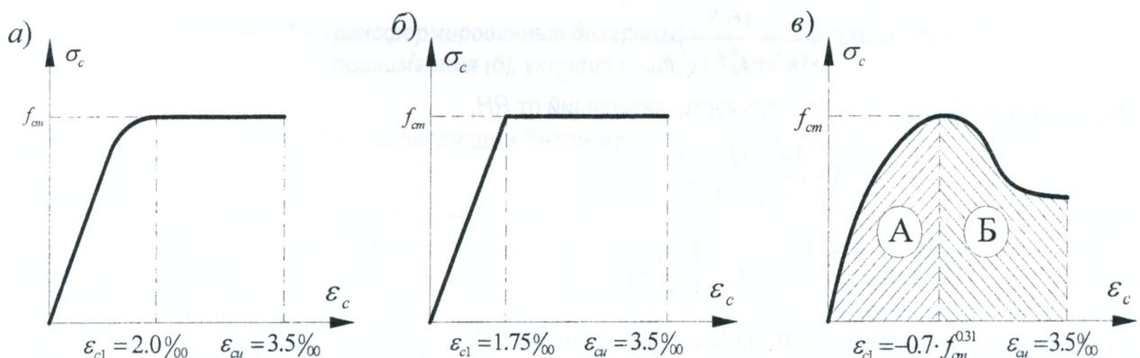
Рисунок 3.4 – Параметрические точки на диаграммах деформирования бетона
