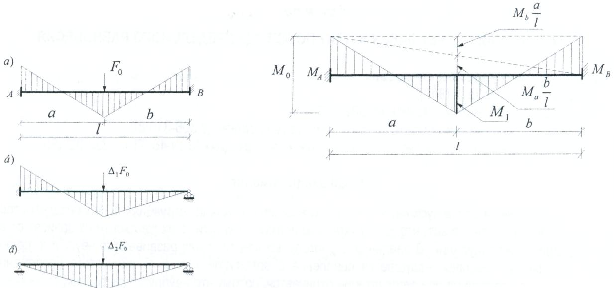
Рисунок 11.1 – Перераспределение усилий в статически неопределенной балке
