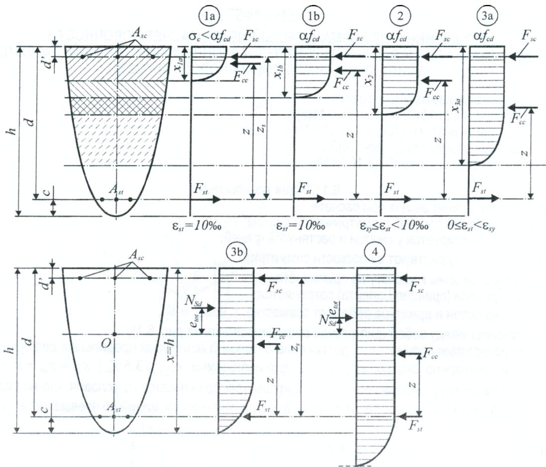
Рисунок 6.2 – Схема усилий в характерных областях деформирования
