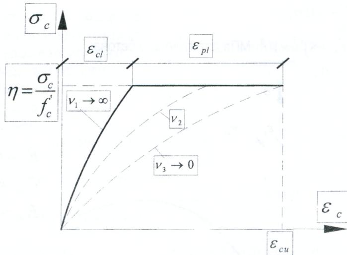
Рисунок 3.5 – Развитие деформации бетона во времени
