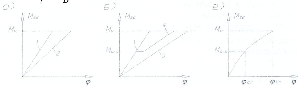
а) – линейно – упругая; б) – двухфазовая; в) – нелинейная
