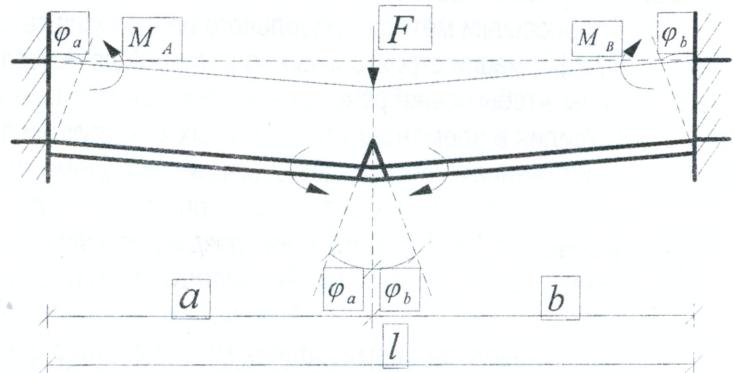
Рисунок 11.2 – Схемы усилий в статически неопределенной балке после появления пластических шарниров
