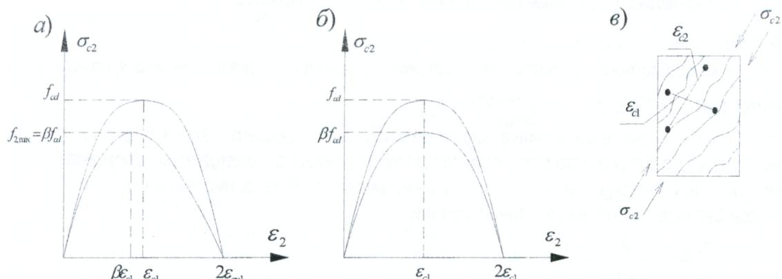
Рисунок 3.7 – Трансформированные диаграммы “ $\sigma – \varepsilon$ ”: фактическая (а), принимаемая (б), условия работы бетона (в)
