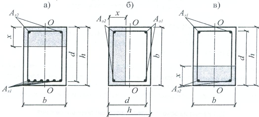
**Рисунок 10.2 – Расчетные положения сжатой зоны пространственного сечения**
