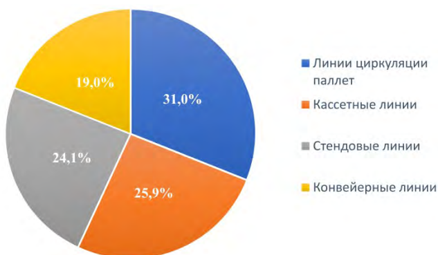
Рисунок 4 – Распределение способов производства основных типов изделий на предприятиях индустриального домостроения
