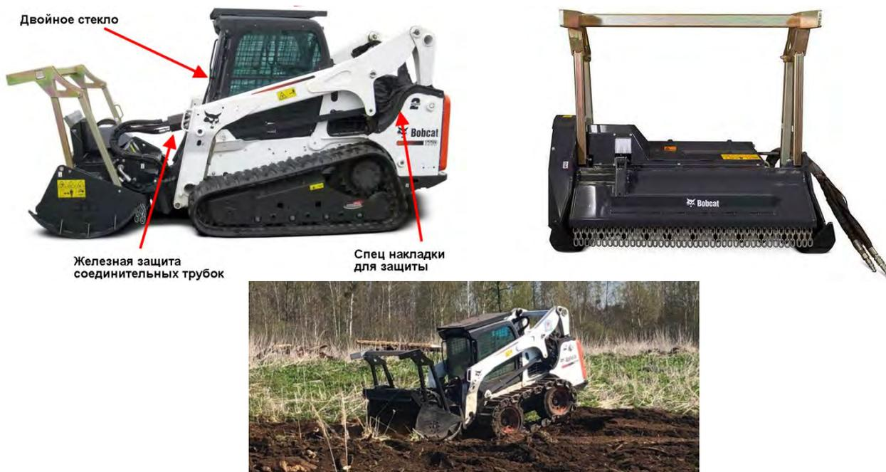
Рисунок 2 – Мобильная дробилка (кусторез) «Bobcat» на базе погрузчика «Bobcat» с бортовым поворотом S770 (общий вид и работа в полевых условиях)
