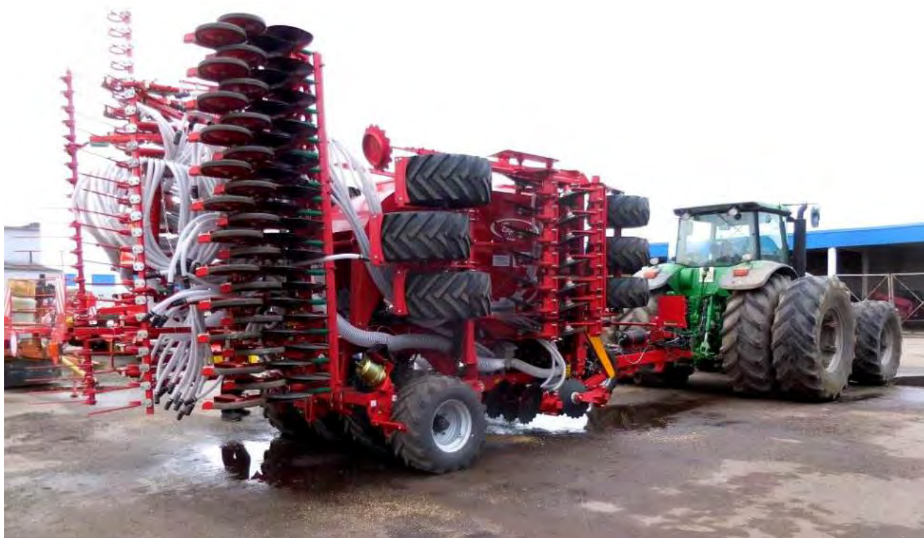
Рисунок 2 – Агрегат АМПШ-6ДСУ33 в транспортном положении с трактором «John Deere 8430»
