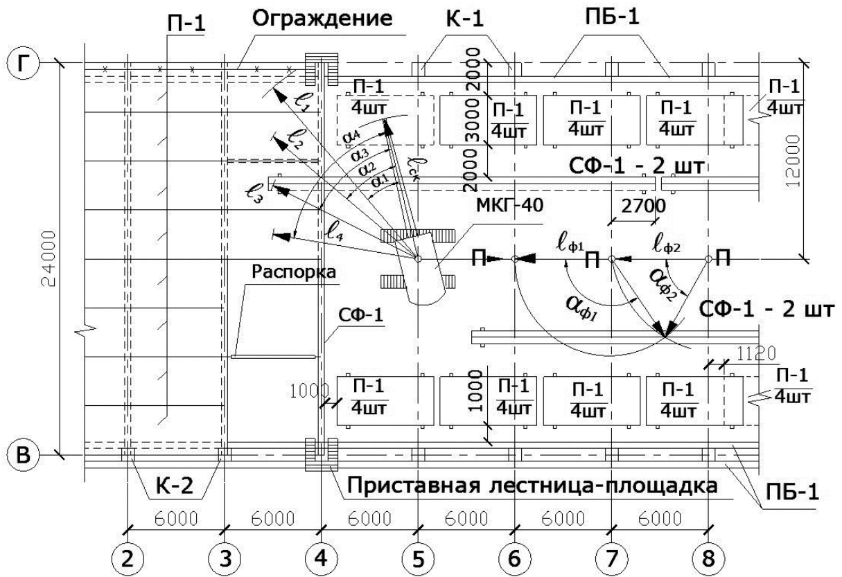
Рисунок 4.4.22 – Схема монтажа железобетонных конструкций покрытия пролетом 24 м
