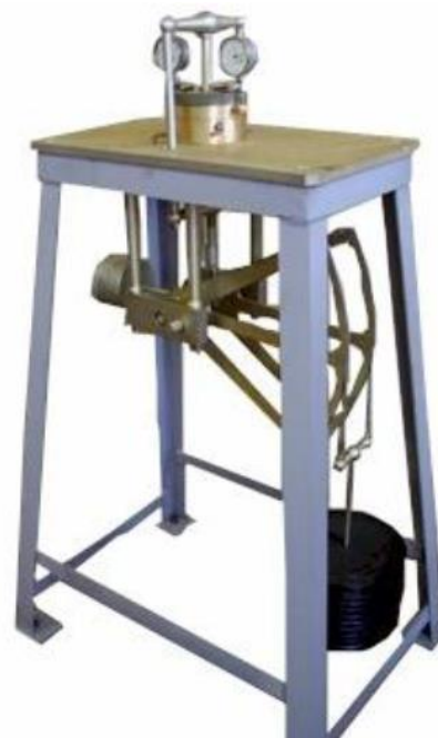
I – стоя; II – одомер, I – опорный винт; 2 – подвеска; 3 – траверса подвески; 4 – трос грузовой; 5 – сектор; 6 – палец; 7 – трос тяговый; 8 – винт натяжной; 9 – нижнее коромысло; 10 – маховичок; 11 – стяжка; 12 – шарик; 13 – верхнее коромысло; 14 – упор; 15 – рычаг, 16 – противовес Рисунок 5 – Настольный компрессионный прибор КПр-1
