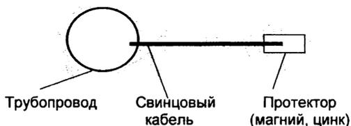
Рисунок 8.6 – Схема защиты металлов от коррозии протекторами
