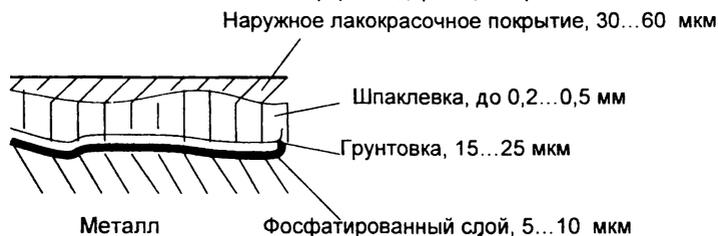
Рисунок 8.3 – Схема лакокрасочного покрытия детали
