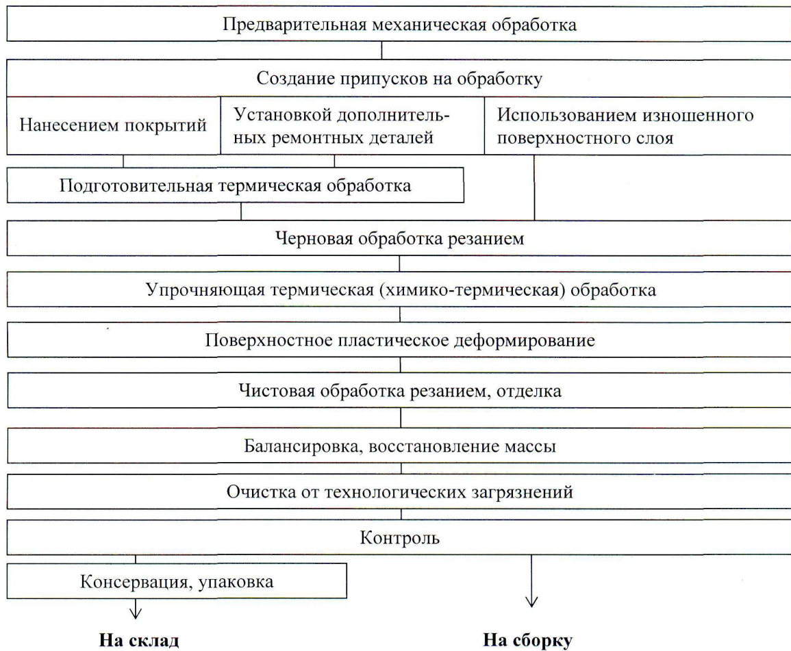
Рис. 1. Схема технологического процесса восстановления деталей
