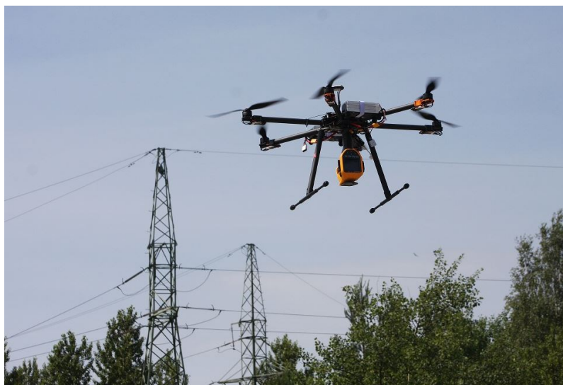
Fot. 6 – Monitorowanie linii wysokiego napięcia (urydio: www.swiatdronow.pl/zastosowania-dronow/monitoring/page/2 ).
