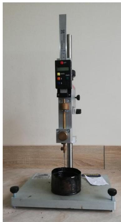
**Рисунок 2.1 – Пенетрометр**
