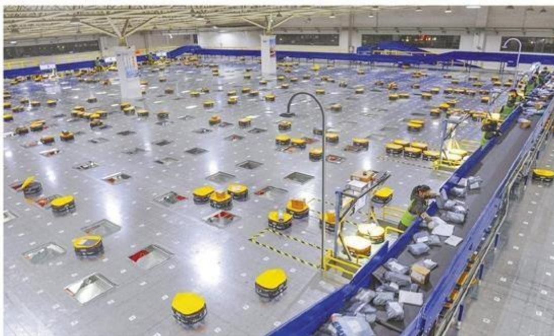
Рисунок 2 – Автоматизированная система экспресс-сортировки посылок в Китае
