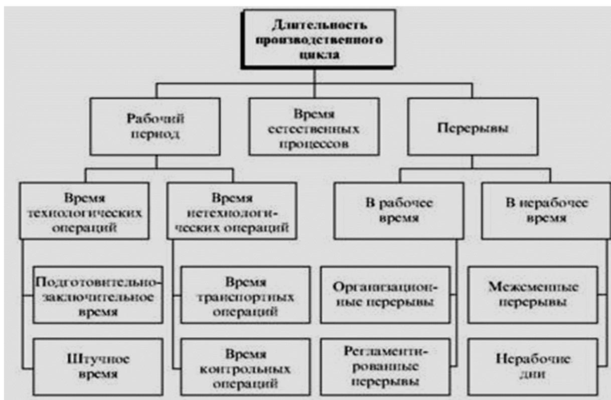
Рисунок 2.15 – Примерная структура производственного цикла
