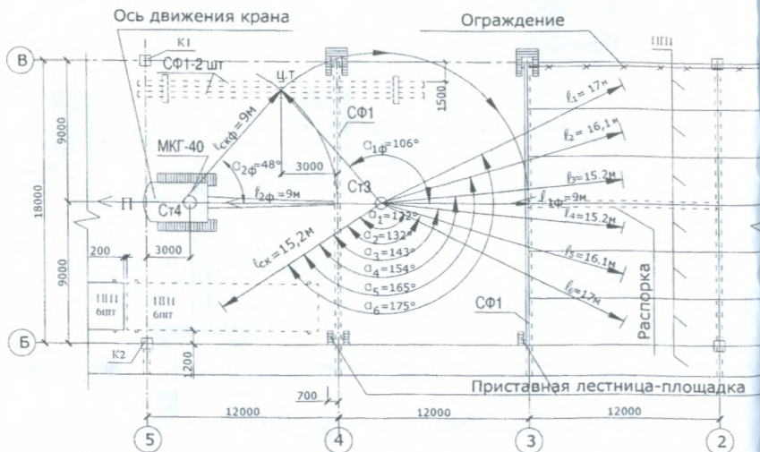
Рисунок 4.4.20 – Схема монтажа конструкций покрытия при пролете 18 м
