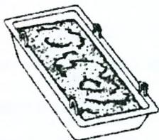
**Металлический растворный ящик** объемом  $0,24 \text{ м}^3$  служат для подачи раствора и устанавливаются на рабочее место каменщика. Допускается подъем в гирлянде (до шести ящиков одновременно).
