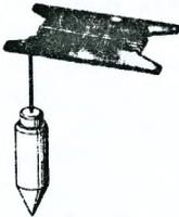
**Отвес** служит для проверки вертикальности стен, простенков, столбов и углов кладки. Отвесом массой 200-400 г проверяют кладку по ярусам и в пределах высоты этажа. Наружные углы здания в пределах высоты нескольких этажей или всего здания проверяют отвесом массой 600-1000 г.
