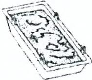
**Металлический растворный ящик** объемом 0,24 м<sup>3</sup> служат для подачи раствора и устанавливаются на рабочее место каменщика. Допускается подъем в гирлянде (до шести ящиков одновременно).
