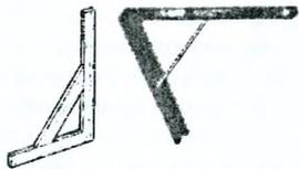
**Угольник** деревянный или металлический размером 500×700 мм служит для разметки и проверки прямых углов каменной кладки.
