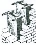
**Буйки** – деревянные и металлические короба с сечением по размерам дымовых или вентиляционных каналов, высотой на 6-8 рядов кладки. Позволяют существенно увеличить производительность труда при кладке вентиляционных каналов в каменных стенах, обеспечивают постоянное сечение канала и предохраняют его от засорения раствором.
