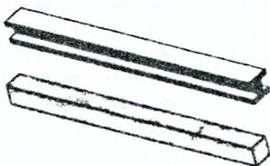
**Правило** – отфугованный деревянный брусок сечением 40×40 мм или дюралюминиевая рейка двутаврового сечения длиной 1,2-2 м. Служит для контроля поверхности выкладываемых стен, а совместно с уровнем, для проверки вертикальности и горизонтальности рядов кладки и в целом конструкций.
