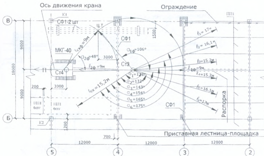
Рисунок 4.4.20 – Схема монтажа конструкций покрытия при пролете 18 м
