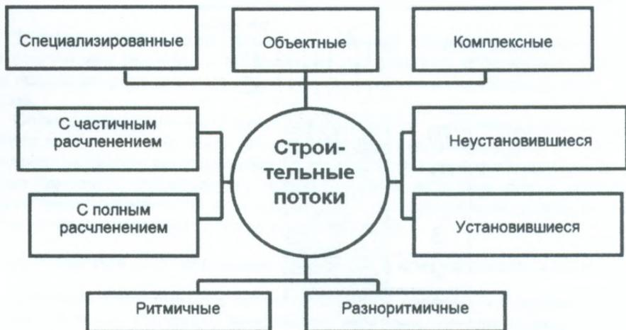
Рисунок 9.4 – Схема разновидностей строительного потока.
