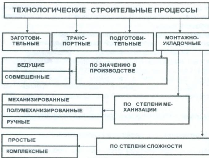
**Рисунок 4.1. Схема классификации строительных процессов.**
