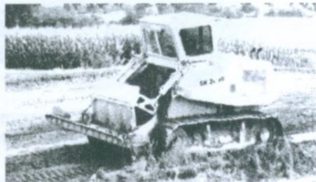
**Рисунок 21.6. Скрепердозер: а) – работа бульдозером; б) – работа скрепером**
