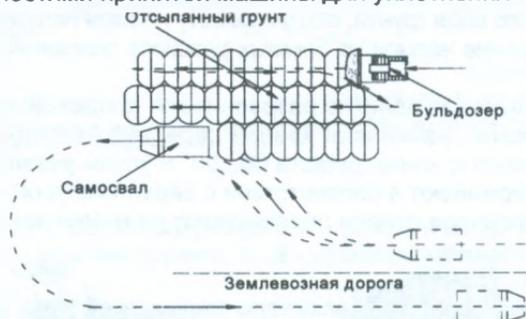
**Рисунок 25.1 – Схема разравнивания грунта, привозимого автотранспортом, при устройстве насыпи.**
