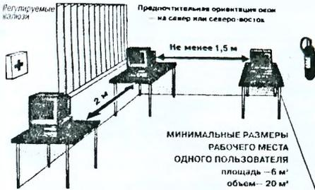
Рисунок 6.2 – Схема размещения компьютеров в помещении
