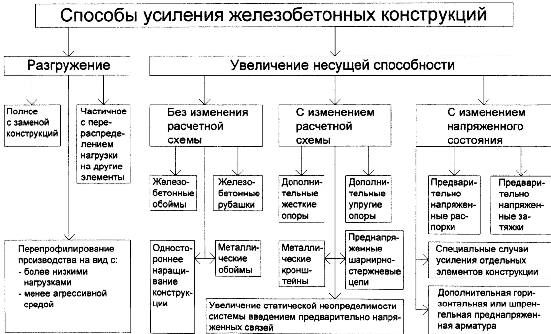
Рисунок 3.1 – Классификация способов усиления железобетонных конструкций
