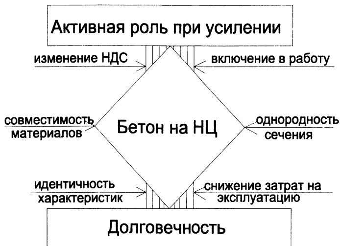
Рисунок 8.1 – Особенности использования напрягающего бетона при усилении
