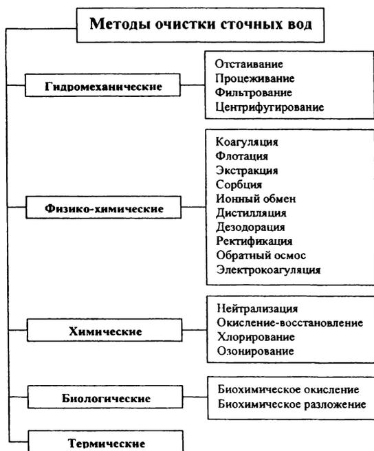
Рисунок 10.9 – Классификация методов очистки сточных вод
