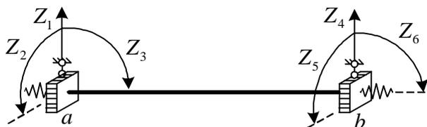
Рисунок 3 – Основная система метода перемещений
