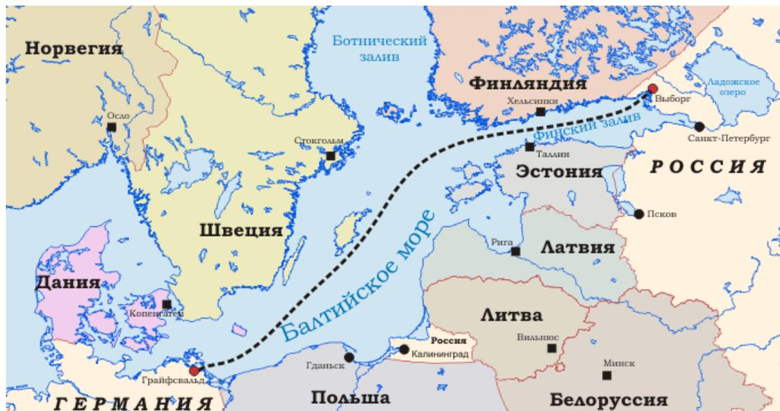
Рисунок 3. Схема магистрального газопровода «Северный поток».
