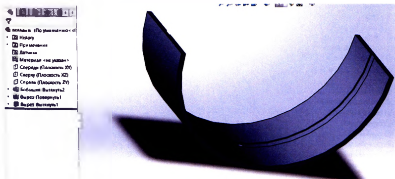
Рисунок 3.8. Дерево построения и твердотельная модель детали 3 «Вкладыш»
