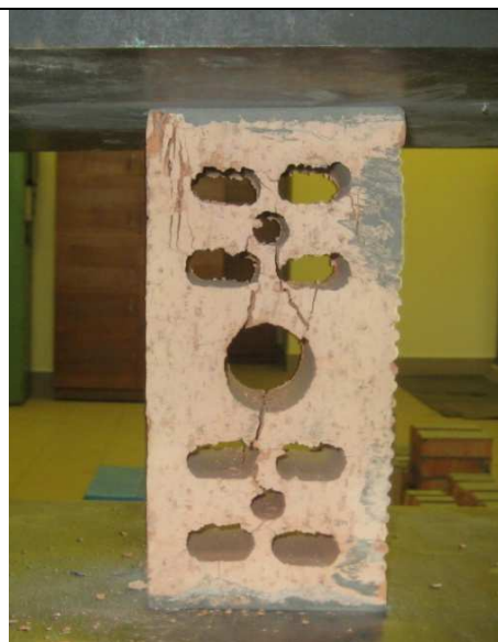
Рис. 1. Характер разрушения опытных образцов кирпича: а) полнотелого КРО-150/25; б) пустотелого КРПУ-125/35
