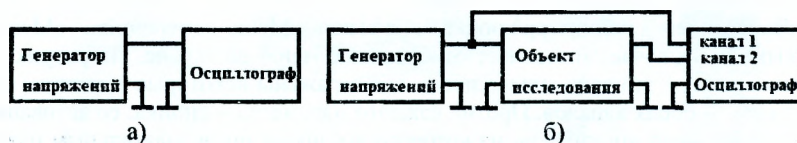
а) – генератора напряжений; б) – входных/выходных сигналов четырехполюсников (например, R, L, C-цепей)
