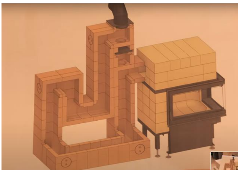
Фото 23 – Схема конструкции печи-камина с разрезом по газовым каналам
