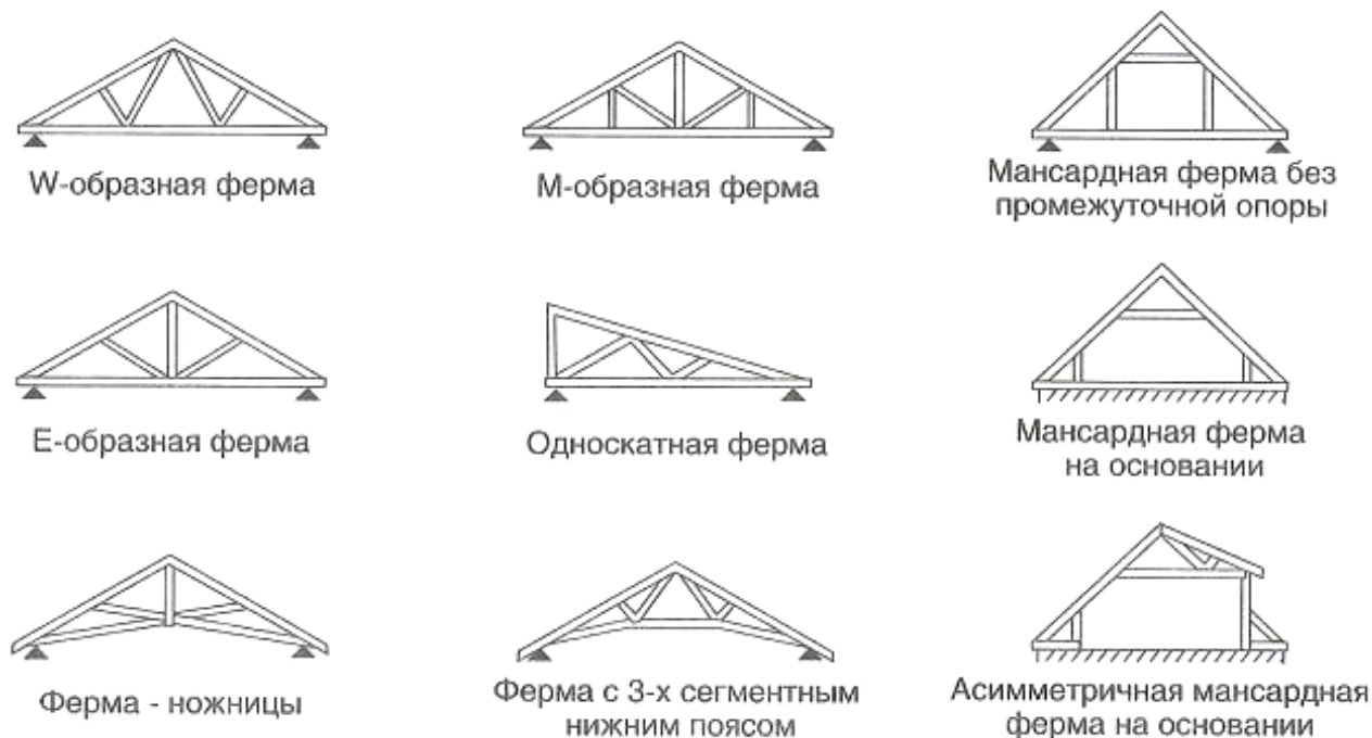
Рисунок 5 – Варианты фермы стропильной системы крыши
