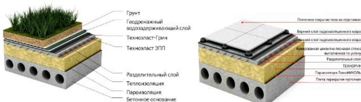
Рисунки 9-10 – Варианты «пирога» плоской эксплуатируемой крыши
