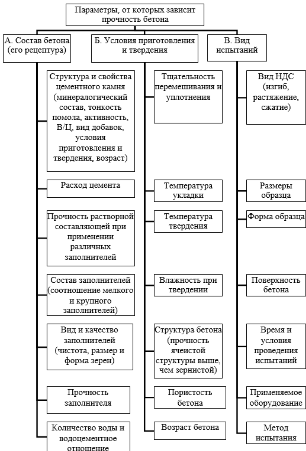
Рисунок 1 – Параметры, от которых зависит прочность бетона
