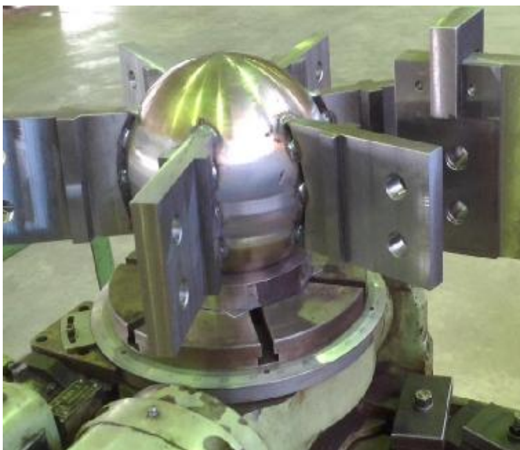
Рисунок 1 –Общий вид узлового элемента в процессе изготовления
