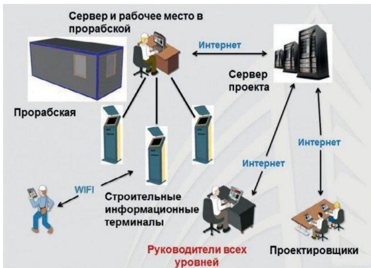
Рисунок 2 – Локальная сеть для участников подготовки строительного производства
