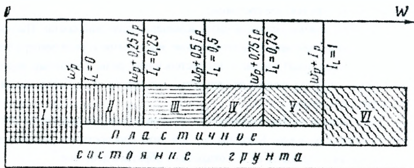
Рис. 153 График состояния глинистых грунтов в зависимости от влажности: I - твердое состояние; II - полутвердое; III - тугопластичное; IV - мягкопластичное; V - текучепластичное; VI - текучее.
