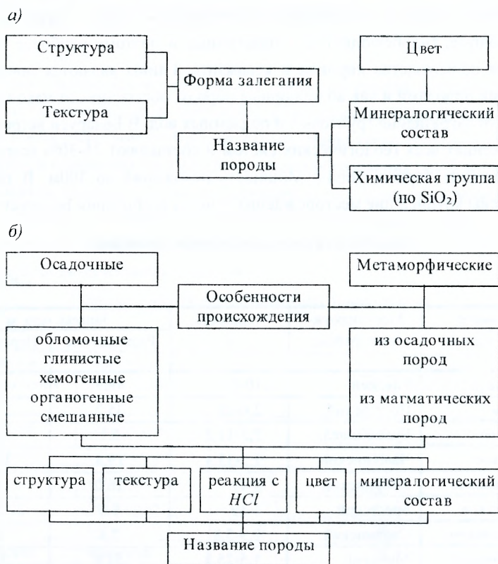
Рис. 12 Ключ-определитель для магматических (а) и осадочных и метаморфических (б) горных пород.
