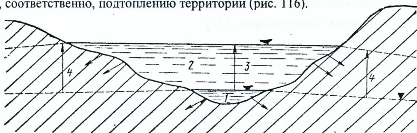
Рис. 116 Влияние уровня водохранилища на грунтовую воду: 1 - река; 2 - водохранилище; 3 - подъем уровня воды; 4 - подъем уровня грунтовой воды.
