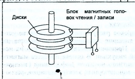
Рис. 3.3.3. Принцип устройства жесткого диска
