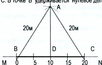
Рис. 29.5. Построение прямого угла при помощи рулетки
