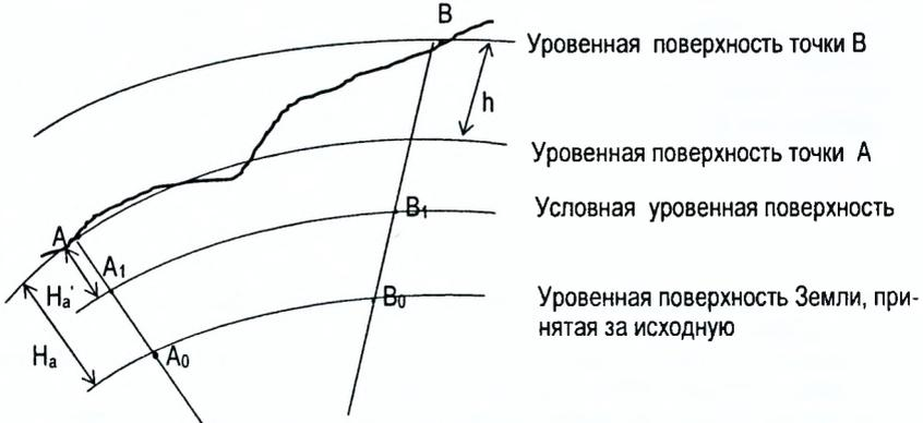
Рис. 4.1. Сечение Земли отвесной плоскостью
