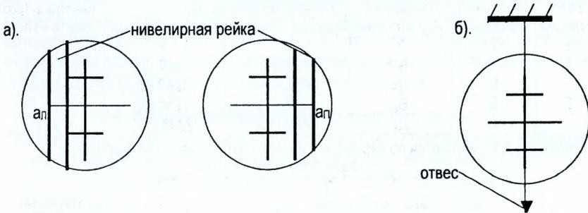
Рис. 2.7 Проверка сетки нитей
