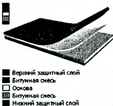
Рисунок 2.8 – Структура кровельного рулонного материала
