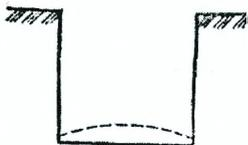
*Рисунок 1.8 – Выпучивание дна котлована*
