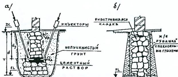
*а* – при разрыве фундамента; *б* – для уменьшения шероховатости поверхности фундаментов с устройством ж/б «рубашки» с наклонными гранями
