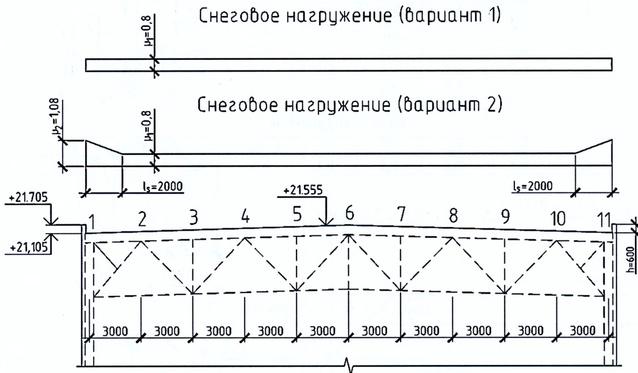
Рисунок 2.2 – Варианты приложения снеговых нагрузок на здание
