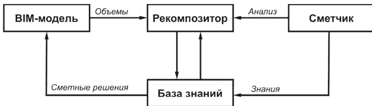
Рисунок 1 – Принципиальная схема функционирования программного комплекса по сметно-экономическим расчетам [17]
