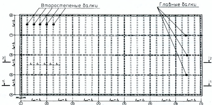
Рисунок 1 – Схема компоновки элементов монолитного ребристого покрытия
