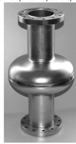
Рисунок 1 – Образцы и изделие, полученные ЭЛС: обратная поверхность сварных соединений меди М1, изготовленных с использованием различных режимов, \times 10 (а, б) и эллиптический СВЧ резонатор из особо чистого ниобия (в)
