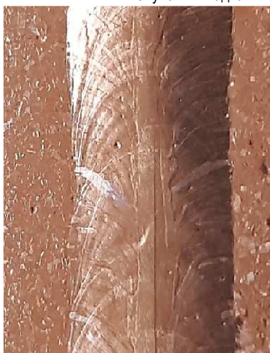
Рисунок 1 – Образцы и изделие, полученные ЭЛС: обратная поверхность сварных соединений меди М1, изготовленных с использованием различных режимов, \times 10 (а, б) и эллиптический СВЧ резонатор из особо чистого ниобия (в)
