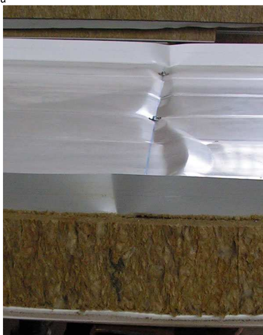
Рис. 7. Характер разрушения образцов панелей при испытаниях по схеме на рисунке 4в
