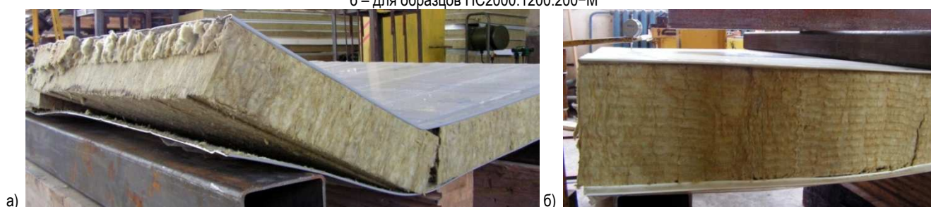
Рис. 3. Характер разрушения образцов панелей при испытаниях на сдвиг
