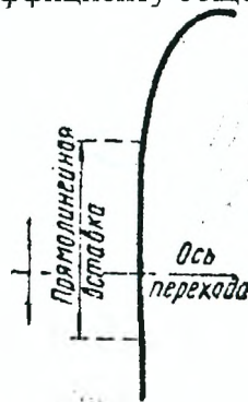
Рис. 8.8. Схема струенаправляющей дамбы с прямолинейной вставкой
