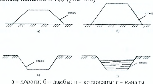
Рисунок 5.6 – Схемы земляных сооружений, имеющих откосы
