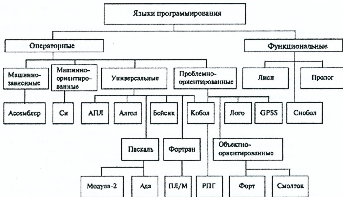
Рисунок 3.29 – Классификация языков программирования
