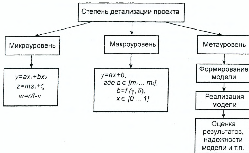
Рисунок 3.9 – Классификация моделей по степени детализации описания объекта или процесса
