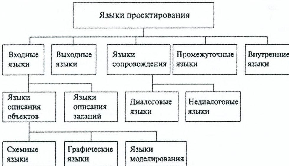
Рисунок 3.30 – Классификация языков проектирования
