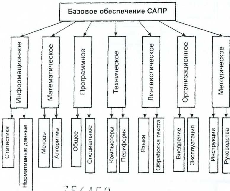
Рисунок 3.1 – Содержание подсистем базового обеспечения САПР
