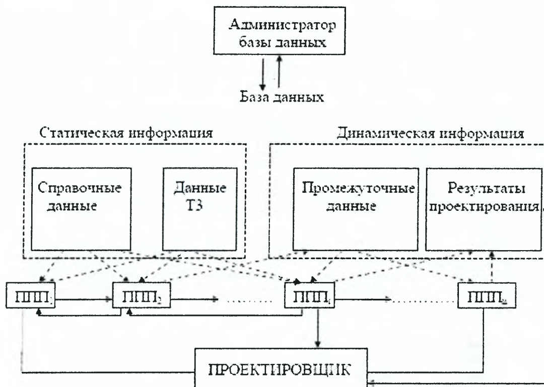
Рисунок 3.5 – Схема информационных потоков в САПР
