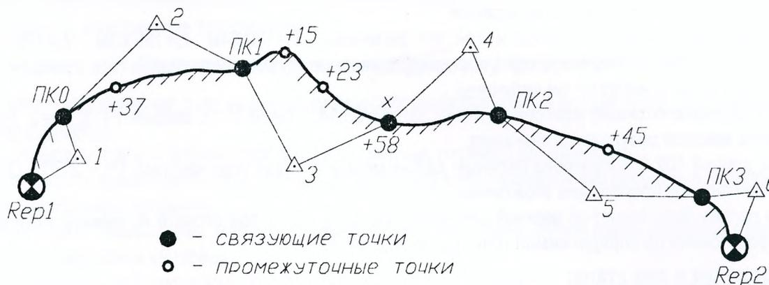
Рисунок 12 – Схема нивелирного хода
