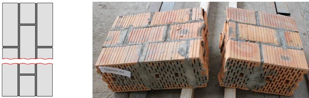
Рисунок 5 – Характер разрушения опытных образцов серии ИП-2
