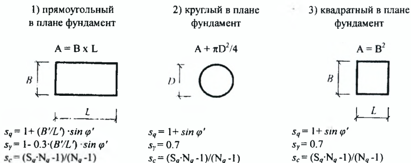
Рисунок 3 – Простые формы, для которых приведены аналитические значения коэффициентов для определения несущей способности их основания
