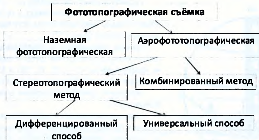
Рисунок 1.18 – Методы фототопографической съемки
