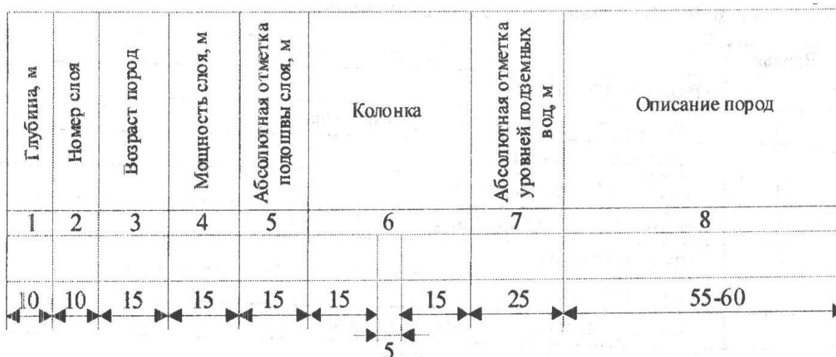
Рисунок 2.1 – Габаритные размеры геологической колонки, мм
