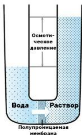
Рисунок 1. Принципиальная схема прямого осмотического процесса.
